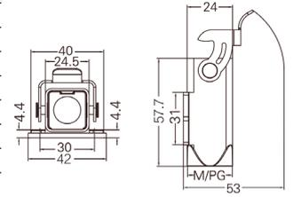
**Кабельный кожух прямой, соединение кабель-кабель**
