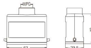
**Кабельный кожух, прямой кабельный ввод, высокая конструкция**
