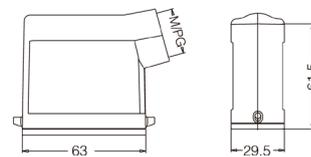
**Кабельный кожух, боковой кабельный ввод, высокая конструкция**
