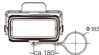
**Защитные крышки с фиксаторами**
