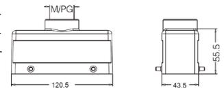
**Кабельный кожух, прямой кабельный ввод, высокая конструкция**
