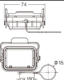
Кабельный кожух боковой и прямой кабельные вводы, высокая конструкция
