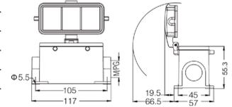
**Кожух блочный накладной, высокая конструкция**
