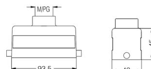
**Кабельный кожух, прямой кабельный ввод, высокая конструкция**
