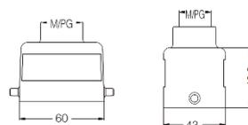
**Кабельный кожух, прямой кабельный ввод, высокая конструкция**
