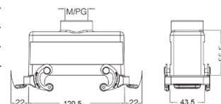
**Кабельный кожух с защелками, прямой кабельный ввод, высокая конструкция**
