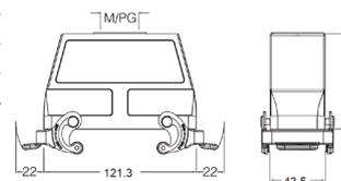
**Кожух блочный проходной с фиксаторами**
