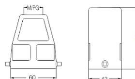
**Кабельный кожух, прямой кабельный ввод, соединение кабель-кабель**
