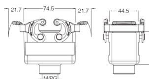
**Кожух кабельный, прямой кабельный ввод, соединение кабель-кабель**
