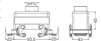
Кабельный кожух, прямой кабельный ввод, высокая конструкция
