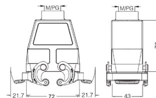
Кожух блочный проходной с фиксаторами
