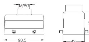
**Кабельный кожух, прямой кабельный ввод, высокая конструкция**
