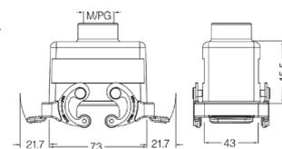
Кабельный кожух с защелками, прямой кабельный ввод, высокая конструкция
