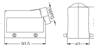
**Кабельный кожух, боковой кабельный ввод, высокая конструкция**
