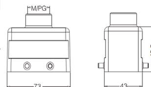
**Кабельный кожух, прямой кабельный ввод, высокая конструкция**
