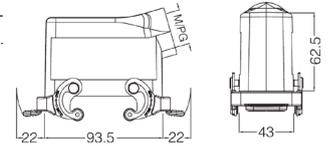
Кабельный кожух, боковой кабельный ввод, высокая конструкция
