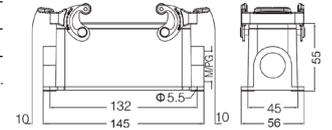
**Кожух блочный накладной, высокая конструкция**
