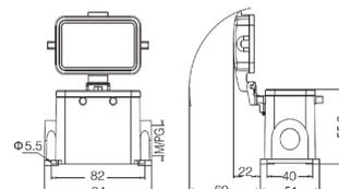
**Кожух блочный накладной с фиксаторами, высокая конструкция**
