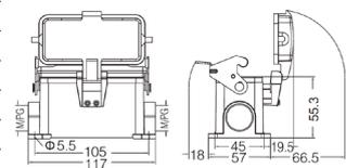
**Кожух блочный накладной, высокая конструкция**
