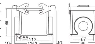
**Кабельный кожух, прямой кабельный ввод, соединение кабель-кабель**
