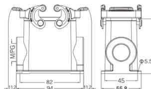
**Кожух кабельный, прямой кабельный ввод, соединение кабель-кабель**
