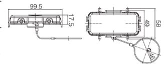
**Защитные крышки металлические для кожухов с фиксаторами**
