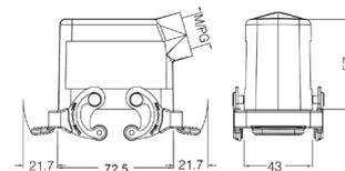
Кабельный кожух с защелками, боковой кабельный ввод, высокая конструкция
