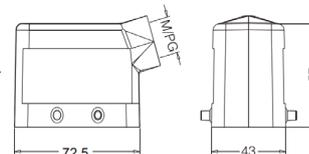
**Кабельный кожух, боковой кабельный ввод, высокая конструкция**
