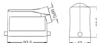
**Кабельный кожух, боковой кабельный ввод, высокая конструкция**
