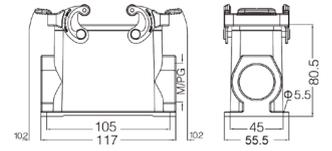
**Кабельный кожух, прямой кабельный ввод, соединение кабель-кабель**
