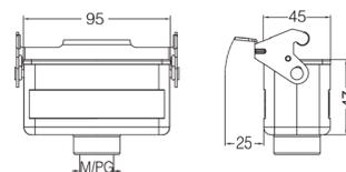
**Кабельный кожух, прямой кабельный ввод, соединение кабель-кабель**
