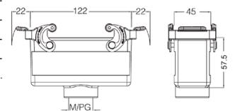
**Кабельный кожух, прямой кабельный ввод, высокая конструкция**
