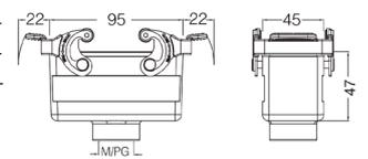
**Кабельный кожух, прямой кабельный ввод, высокая конструкция, соединение кабель-кабель**
