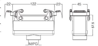
**Кабельный кожух, прямой кабельный ввод, высокая конструкция**
