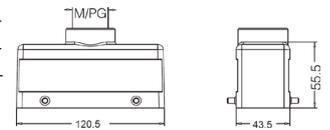
**Кабельный кожух, прямой кабельный ввод, высокая конструкция**
