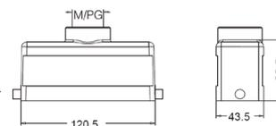
**Кабельный кожух, прямой кабельный ввод, высокая конструкция**
