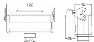
**Кабельный кожух, прямой кабельный ввод, соединение кабель-кабель**
