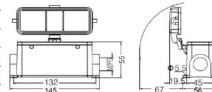
**Кожух блочный накладной с фиксаторами, высокая конструкция**
