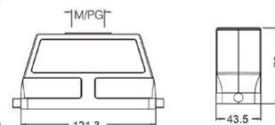
**Кабельный кожух, прямой кабельный ввод, соединение кабель-кабель**
