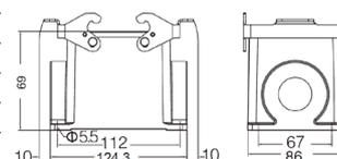
**Кабельный кожух, прямой кабельный ввод, соединение кабель-кабель**
