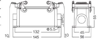
**Кожух блочный накладной, высокая конструкция**
