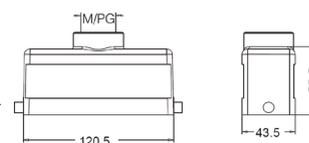
**Кабельный кожух, прямой кабельный ввод, высокая конструкция**
