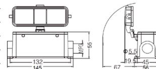
**Кожух блочный накладной с фиксаторами, высокая конструкция**
