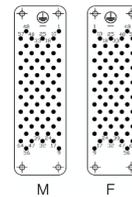
Монтажный вырез в панели при использовании контактных вставок без кожухов (корпусов)
