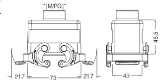
Кабельный кожух с защелками, прямой кабельный ввод, высокая конструкция
