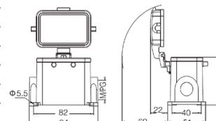
**Кожух блочный накладной с фиксаторами, высокая конструкция**
