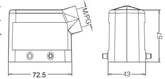
Кабельный кожух, боковой кабельный ввод, высокая конструкция
