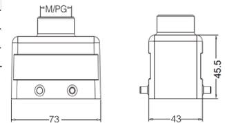
Кабельный кожух, прямой кабельный ввод, высокая конструкция
