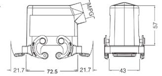
Кабельный кожух с защелками, боковой кабельный ввод, высокая конструкция
