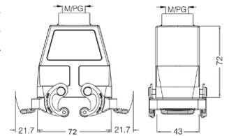
Кожух блочный проходной с фиксаторами
