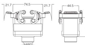
**Кожух кабельный, прямой кабельный ввод, соединение кабель-кабель**
