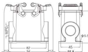
**Кожух кабельный, прямой кабельный ввод, соединение кабель-кабель**
