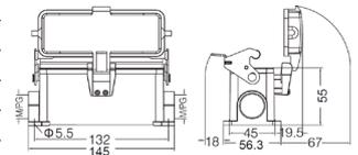
Кожух блочный накладной, высокая конструкция
