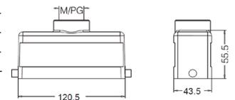
**Кабельный кожух, прямой кабельный ввод, высокая конструкция**
