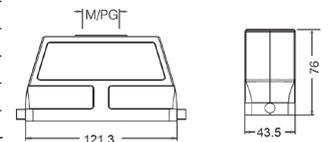
**Кабельный кожух, прямой кабельный ввод, соединение кабель-кабель**
