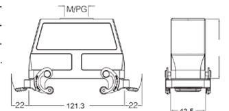
Кожух блочный проходной с фиксаторами
