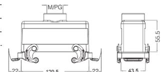
Кабельный кожух с защелками, прямой кабельный ввод, высокая конструкция
