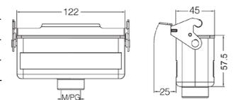
**Кабельный кожух, прямой кабельный ввод, соединение кабель-кабель**
