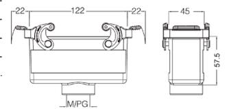
**Кабельный кожух, прямой кабельный ввод, высокая конструкция**
