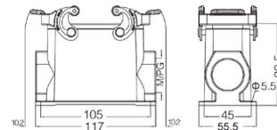
**Кабельный кожух, прямой кабельный ввод, соединение кабель-кабель**
