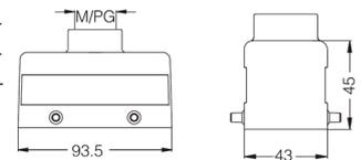
**Кабельный кожух, прямой кабельный ввод, высокая конструкция**
