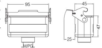
**Кабельный кожух, прямой кабельный ввод, соединение кабель-кабель**
