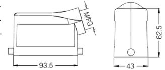
**Кабельный кожух, боковой кабельный ввод, высокая конструкция**
