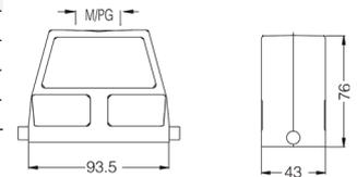
**Кабельный кожух, прямой кабельный ввод, соединение кабель-кабель**
