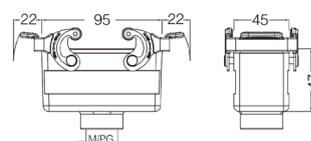
**Кабельный кожух, прямой кабельный ввод, высокая конструкция, соединение кабель-кабель**
