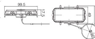
**Защитные крышки металлические для кожухов с фиксаторами**
