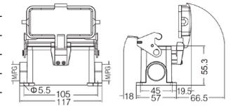
**Кожух блочный накладной, высокая конструкция**
