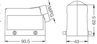
**Кабельный кожух, боковой кабельный ввод, высокая конструкция**
