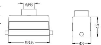
**Кабельный кожух, прямой кабельный ввод, высокая конструкция**
