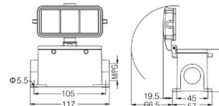
**Кожух блочный накладной, высокая конструкция**
