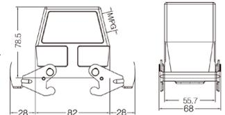
Кабельный кожух, прямой кабельный ввод, высокая конструкция, с защелками
