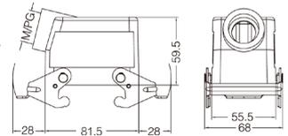
Кабельный кожух, боковой кабельный ввод, высокая конструкция, с защелками
