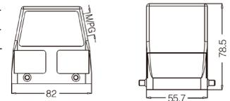
**Кабельный кожух, прямой кабельный ввод, высокая конструкция**
