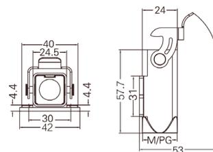
**Кабельный кожух прямой, соединение кабель-кабель**
